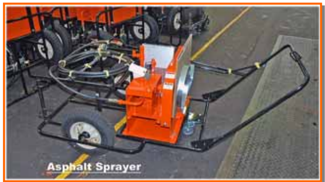
【写真-11:現地で必要な小型アスファルト散布機械】
