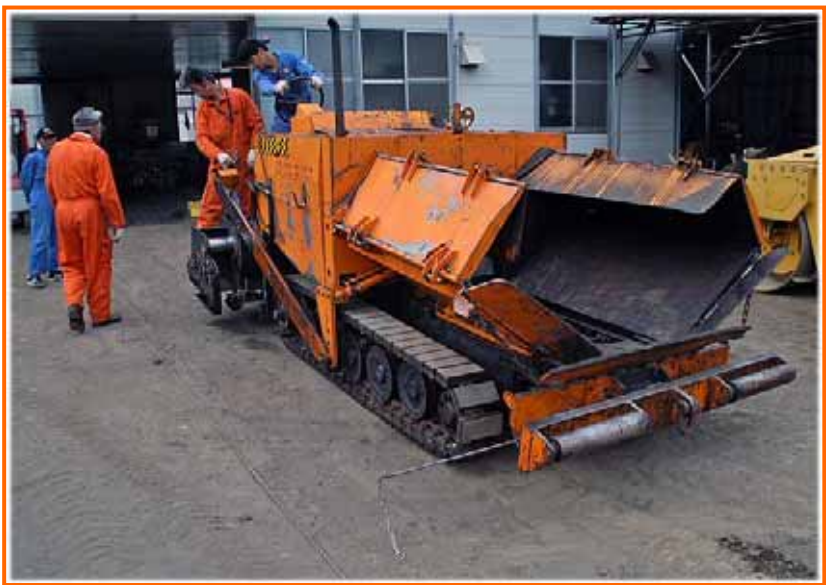
【写真-27:整備後の後、5-10年使えるアスファルトフィニッシャ】
