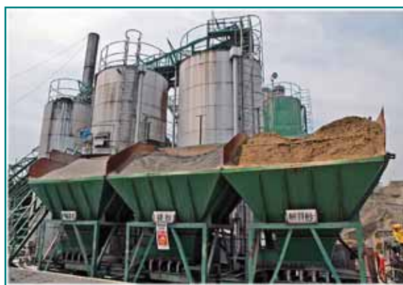
【写真-17: アスファルト合材用の原材料投入ホッパー】
