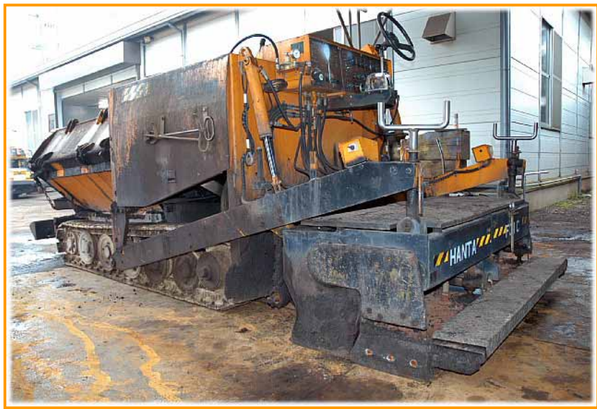
【写真-24:整備前の中古のアスファルトフィニッシャ】
