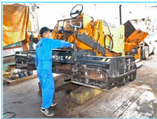
【写真-35：自ら40日掛けて再生したフィニッシャの完成後、仕上げの清掃をする研修生の Mr.Karma】
