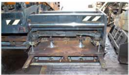
【写真-26:交換したバーナとアイロンプレート】
