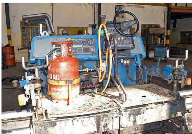
【写真-7:LPGバーナー改修工事が済んだPaver】
