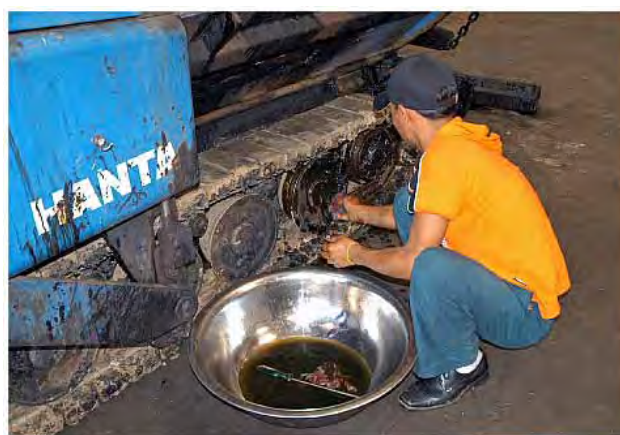
【写真-9:軽油を使ったトラックリンク周りの合材清掃作業】
