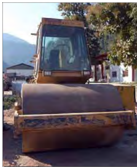
【写真-25: 大型過ぎて利用されていないタンデムローラ】
