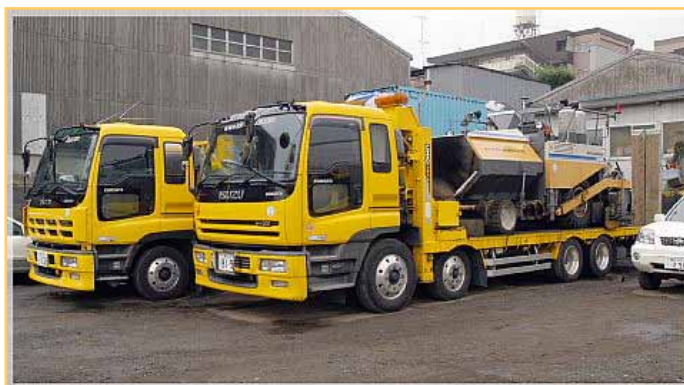
写真9 - 3 作業性、安全性から使用が望まれる、道路整備機械運搬用のセルフローダ
