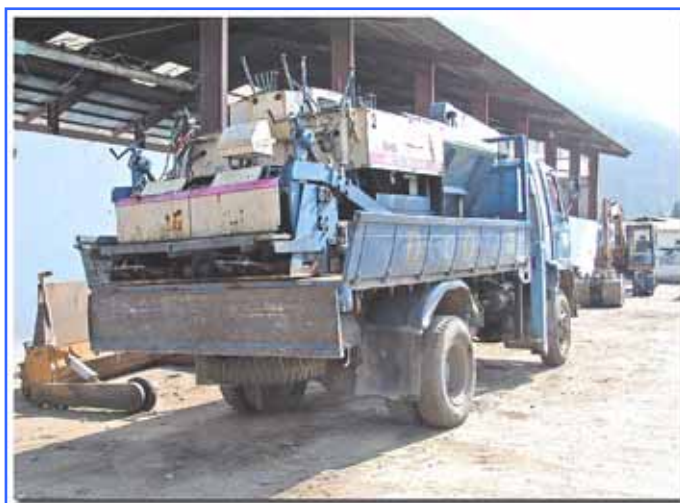
写真9 - 2 カーゴトラックを使ったフィニッシャの運搬荷姿
