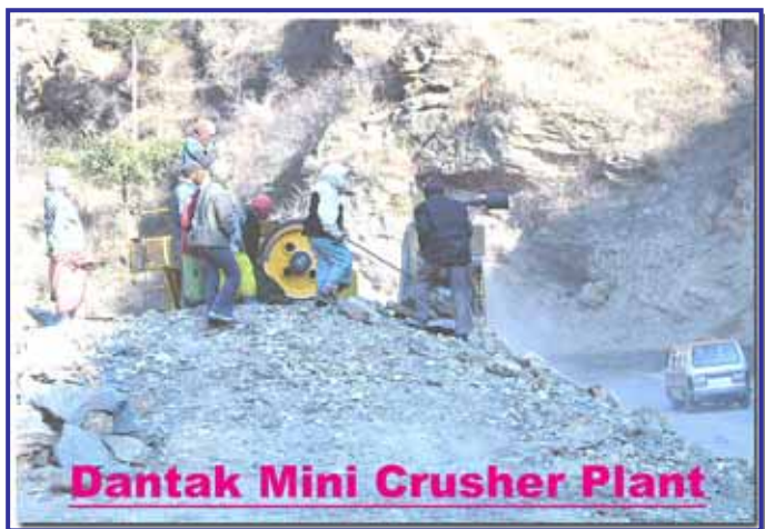
写真5 - 3 インド陸軍 DANTAK が管理する道路整備で使用している小型クラッシャー
