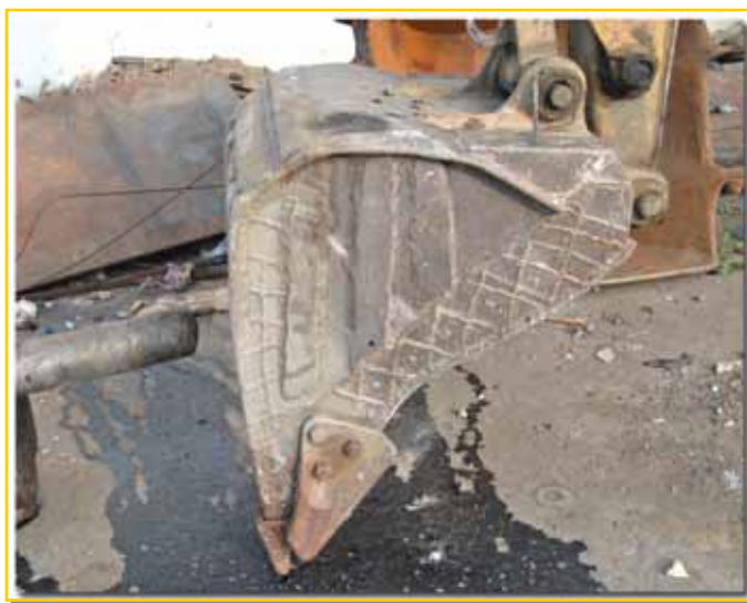
写真8-3 ソタンカ中央整備工場で、再々生して使われている建設機械用のバケット
