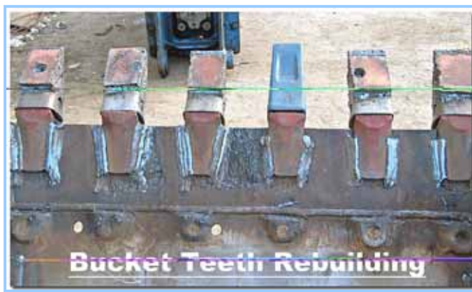
写真8-3 ソタンカ中央整備工場で、溶接肉盛再生作業中のバケットと爪
